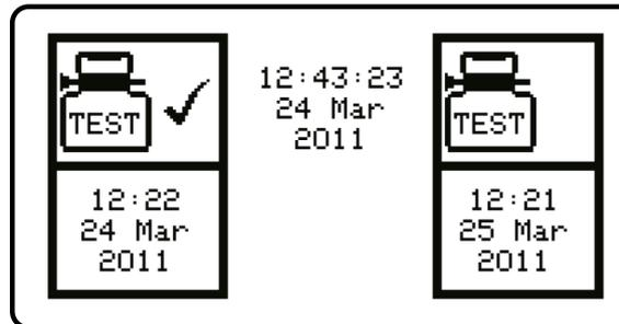
A próxima tela indica a data e hora da última calibração do Gas-Pro. Também indica a data de vencimento da calibração, com um símbolo de alerta
