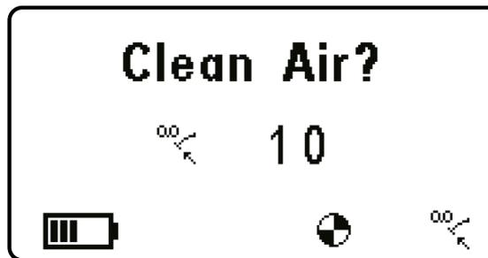
O Autozero não deve ser realizado se o Gas-Pro não estiver em ambiente com ar limpo. Pressione o botão do operador (liga / desliga) para entrar no modo Autozero, ou então aguarde o fim da contagem regressiva para não realizar o zero.
