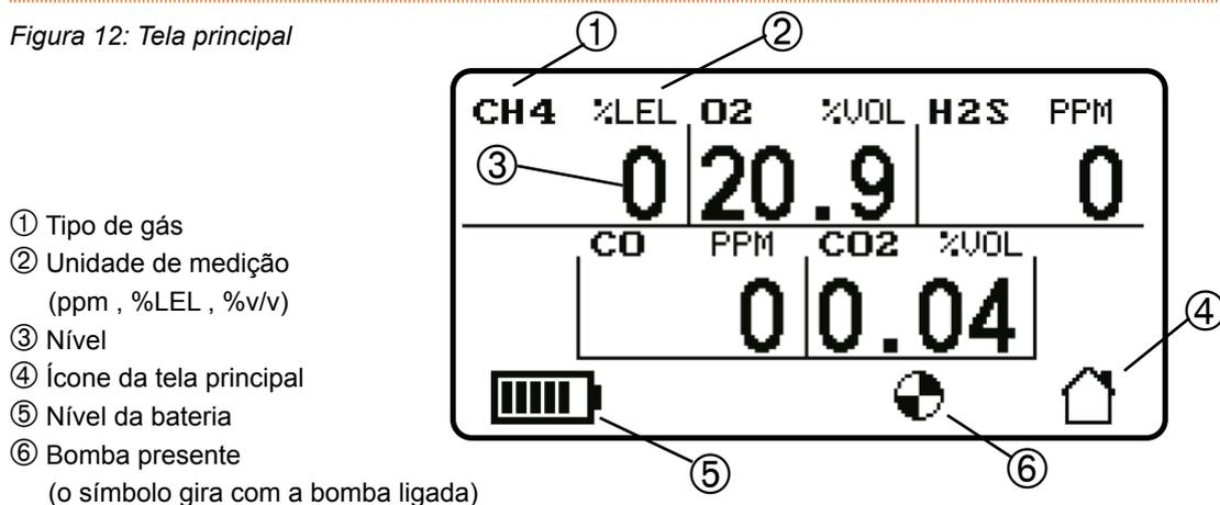
Em “ar limpo”, os níveis de CO<sub>2</sub> e Oxigênio geralmente são de 0,04% e 20,9%, respectivamente. No modo zero, é feito o zero com compensação para esses gases.
