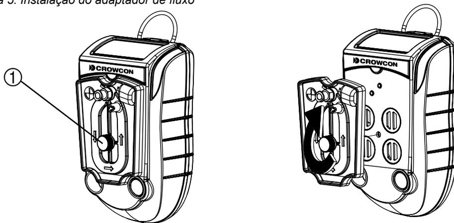
O adaptador de fluxo possui uma conexão de engate rápido para tubos de amostragem e sondas.
