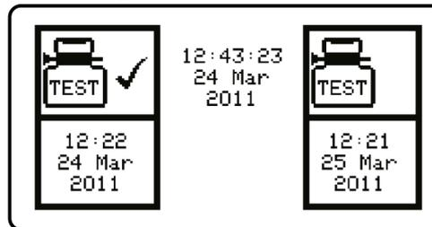
O Gas-Pro não informará ao usuário sobre a necessidade de realizar o teste de resposta até vencer o respectivo intervalo desde o último teste de resposta aprovado. Contudo, com a instalação de um adaptador de fluxo magnetizado, ou com a colocação do Gas-Pro no Q-Test, o usuário terá a opção de realizar o teste de resposta (ou prosseguir ao funcionamento com bomba).
