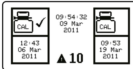
Se o bloqueio por vencimento da calibração estiver ativado, o ícone de bloqueio
