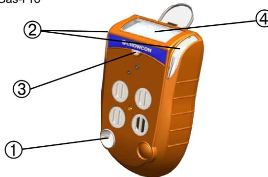
Na condição de alarme, o Gas-Pro vibra, o alarme sonoro ① emite um toque intermitente rápido, os LEDs de alarme ② piscam nas cores vermelha e azul, o indicador +ve Safety™ ③ se apaga em estado de alarme e a tela de LCD ④ exibe a cor de fundo vermelha, destacando o gás alarmado.
