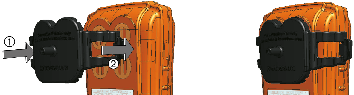
Figura 5: Instalação do adaptador de calibração/teste de resposta
