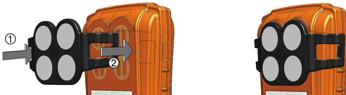
Figura 6: Instalação do adaptador de filtros externos
